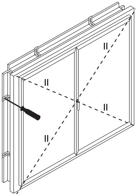
**4.** Mettre un joint de silicone entre les tapées et la porte et dans les angles des tapées.
