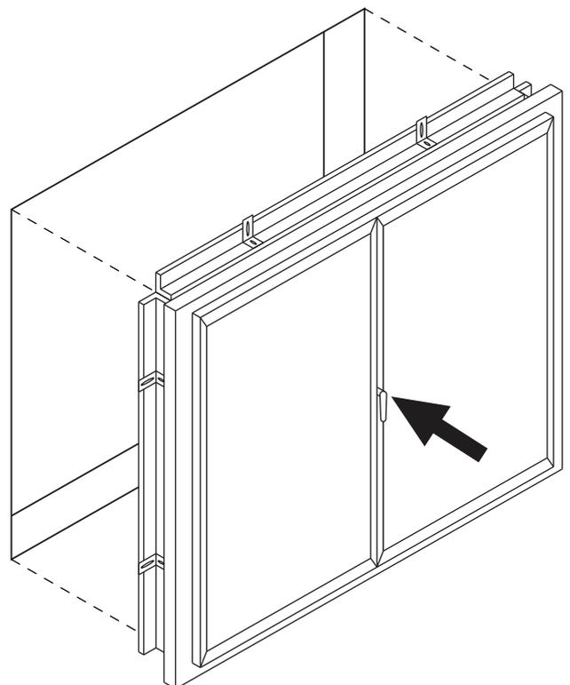
**3.** - Vérifier le niveau d'aplomb et équerrage (diagonales identiques).
