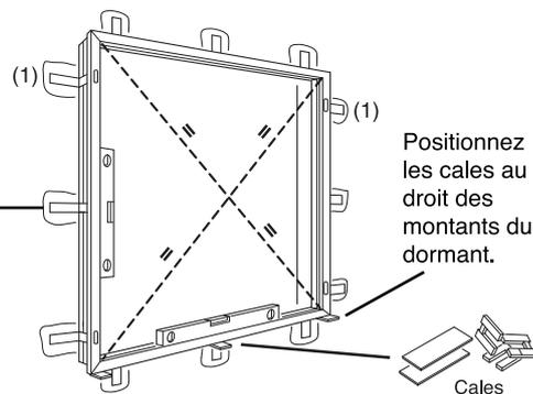
Positionnez le dormant dans le tableau. Vérifiez le niveau et corrigez l'aplomb à l'aide de cales si besoin est.
