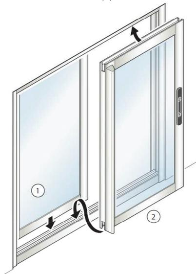
6. Les quatre roulettes situées sous les coulissants (une roulette de chaque côté des coulissants), sont réglables à l'aide d'une clé allen. Mettez le vantail en position fermée. Réglez la vis de la roulette comme indiquée ci-dessus jusqu'à mettre le vantail parallèle au montant. Faites la même opération avec les deux roulettes des deux vantaux
