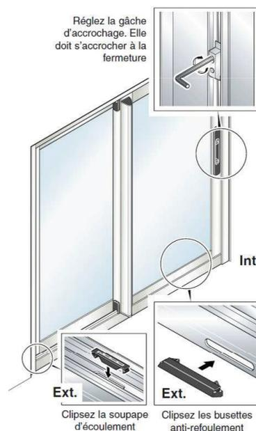
Clipsez la soupape d'écoulement
