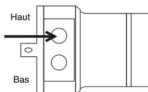
1. Tourner la vis "haut" pour régler la position de la limite d'ouverture
