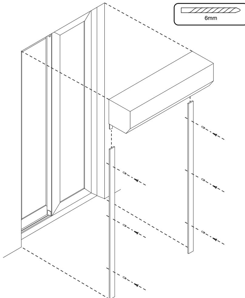
1. Mettre les coulisses sur les encastresments du caisson du volet roulant.
