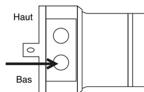
2. Tourner la vis "bas" pour régler la position de la limite de fermeture
