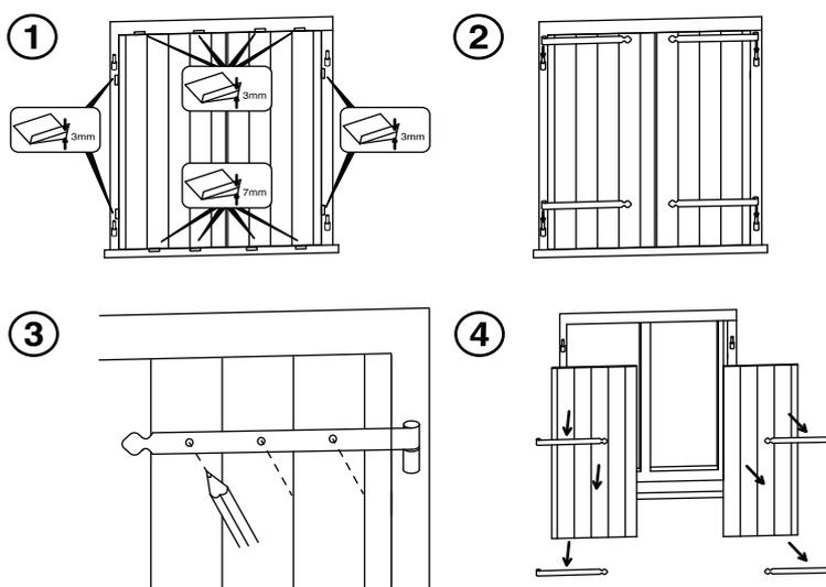
**2. Percer les trous et assembler la penture et la contre-penture grâce aux boulons.**
