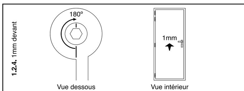
2. Réglage gauche, droite et pour l'arrière (En cas de besoin pour bouger la porte vers l'arrière, enlever la porte des gonds pour effectuer ce réglage).
