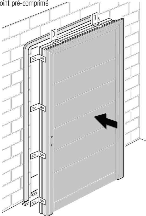
La porte doit complètement écraser le joint pré-comprimé
