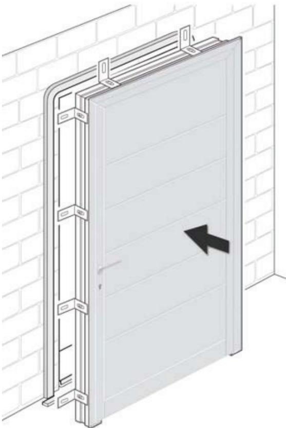
La porte doit adhérer complètement sur le joint précomprimé
