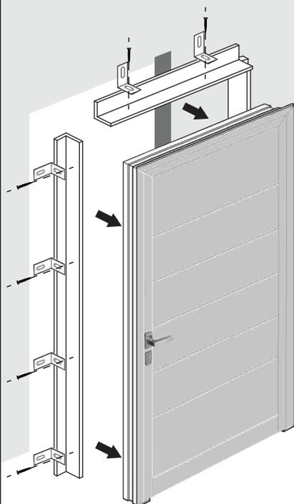
Mettre les vis de fixation des tapées sur les équerres
