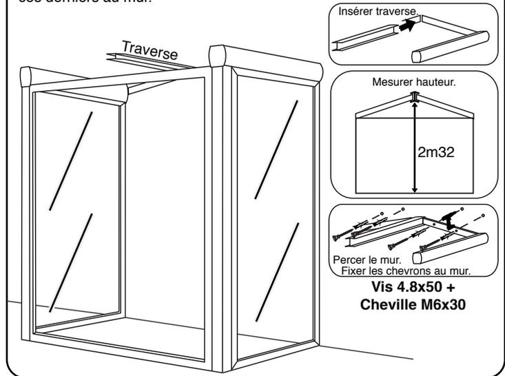
8. Insérer ensuite les 2 plaques de Polycarbonates sur la traverse centrale en les vissant dessus. Placer maintenant les 2 joints sur les côtés de cette même traverse puis les visser également. Penser à silicuner ensuite les côtés fixés des polycarbonates et du SAS.
