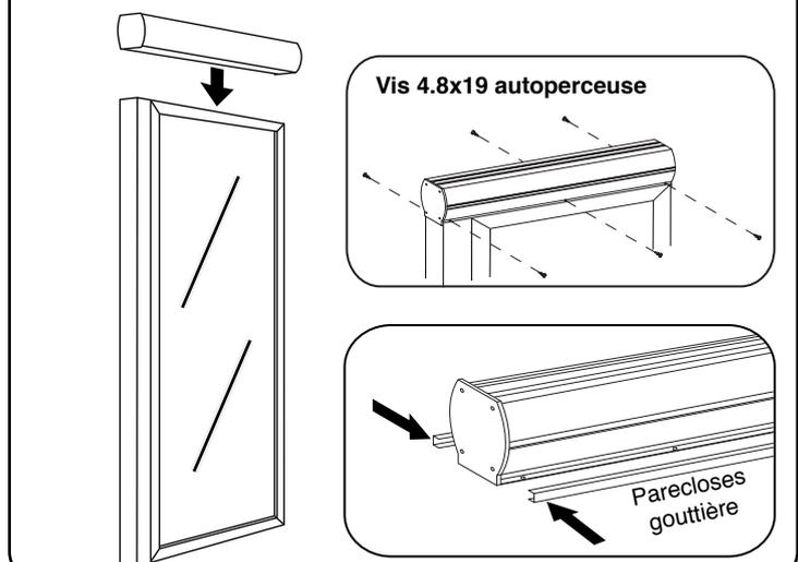
5. Mesurer la largeur de votre SAS et placer les parecloses au mur en fonction de cette mesure. Attention de prendre en compte en plaçant les parecloses de laisser une marge de 0,5cm de chaque côté afin d'emboîter correctement le SAS. Ensuite visser-les au mur puis placer le SAS dessus. Silicuner ensuite les parties fixées au mur et au sol.
