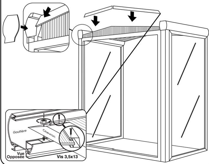
11. Siliconer la plaque frontale de polycarbonate au dormant et aux chevrons avants. Mettez ensuite en place votre vantail gauche en premier dans le rail intérieur.
