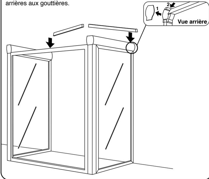
7. Emboîter maintenant la traverse centrale aux chevrons arrière. Mesurer la hauteur du SAS puis marquer cette même mesure sur le mur. Percer le mur avec foret 6mm là où seront fixer les chevrons. Puis visser ces derniers au mur.
