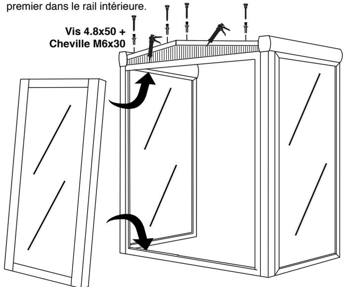
12. Emboîter le couvercle central par-dessus les chevrons avants. Puis mettez en place le vantail droit dans le rail extérieur.
