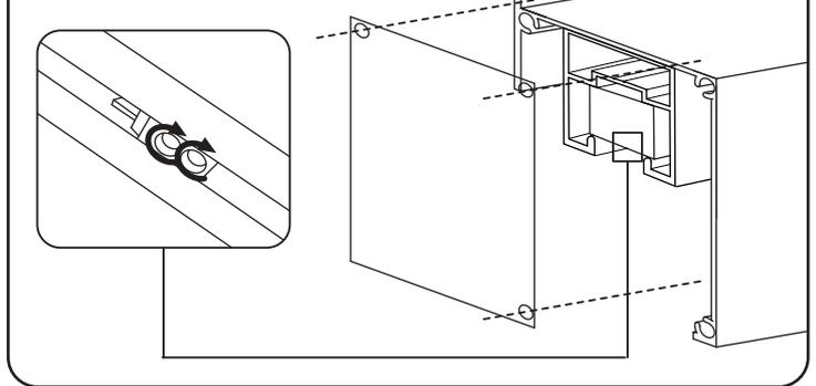
8. Mettre les cales au prolongement du guide, poser la porte sur les cales, le guide devant s'insérer sur la traverse basse de la porte et delimitier l'emplacement pour les fixations (le double chariot doit être clipper sur la butée dans la position de la porte ouverte).
