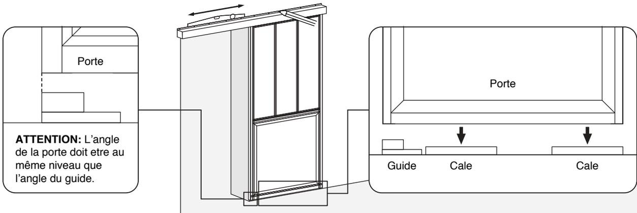
9. Percer et visser le rail au mur (Vis 4,8x60 + cheville + bouchon) ( - 8mm).
