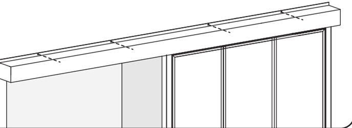
10. Retirer le cale et ajuster les butées et le rail de guidage (si nécessaire).
