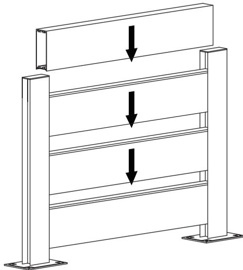
5. Fixer la lame supérieure au montant avec un équerre (Vis 4,8x13).
