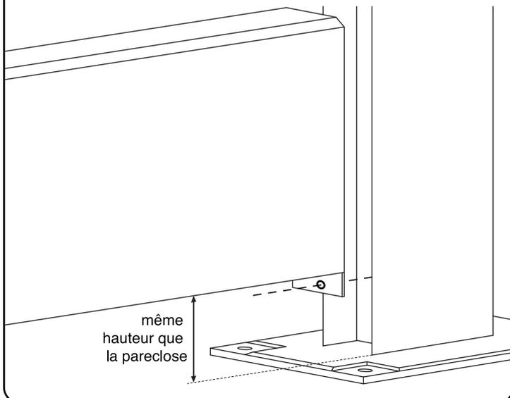
4. Placer les autres lames (▲) sur le traverse du bas jusqu'à la dernière lame (■).
