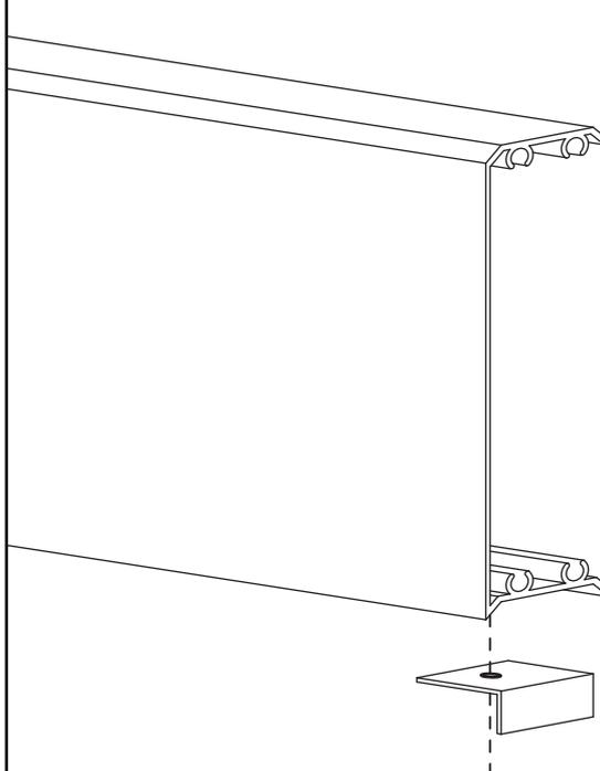
3. Fixation de la lame au montant. Vous devez fixer les équerres à la même hauteur que la pareclose (Vis 4,8x13).
