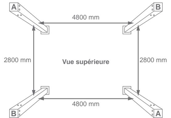
**A** Trous supérieurs sur la face droite des trous inférieurs. **B** Trous supérieurs sur la face gauche des trous inférieurs.
