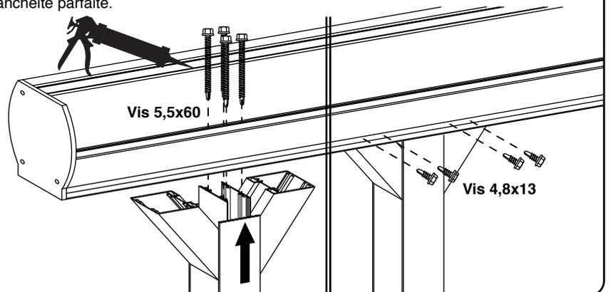
4. Mettre la plaque de polycarbonate à partir du premier chevron. Fixez-la à la faitière et à la gouttière (pour celle-ci, visser en serrant les écrous de la vis Clamos).
