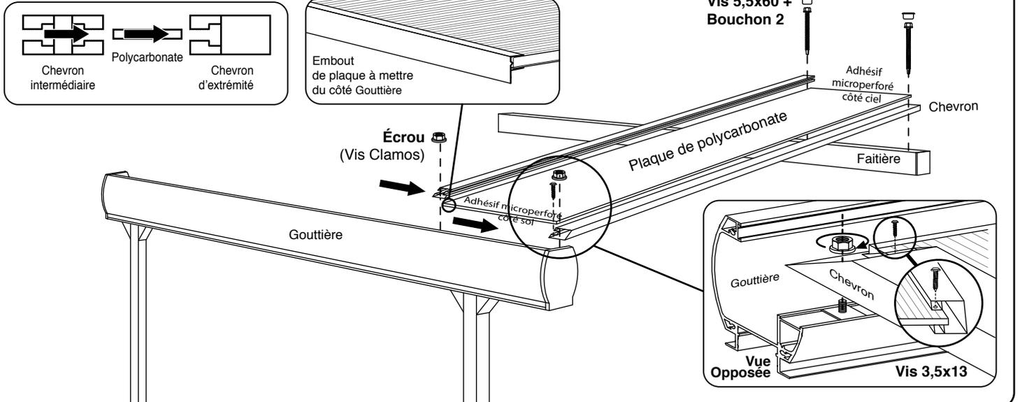
5. Mettre les plaques de polycarbonate en butée jusqu'au dernier chevron. Fixer-les à la faitière et à la gouttière (pour celle-ci, visser en serrant les écrous de la vis Clamos).
