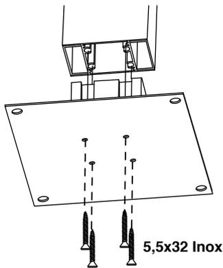
3. Visser la gouttière aux poteaux et siliconer les têtes de vis afin de réaliser une étanchéité parfaite.
