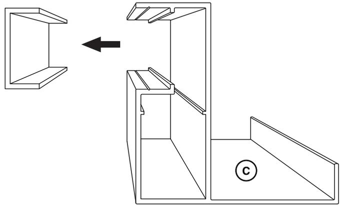
3. Visser et siliconer les poutres gouttières aux piliers (Écrou). **ATTENTION:** Adapter vos fixations à votre support.
