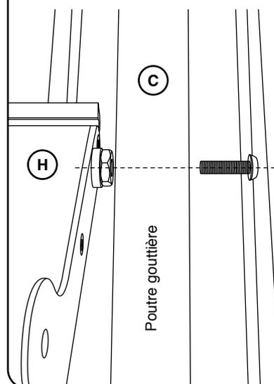
9. Placer la tringle sur les côtés (aux dessus des poutres gouttières) et visser sur l'oreillette percée de chaque lame (Vis Clamos + Rondelles Inox & Téflon).
