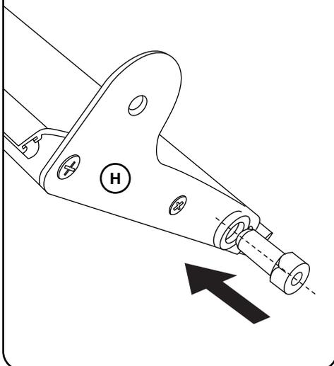
8. Positionner la lame et la deuxième partie de la vis afin de mettre définitivement en place la lame, puis serrer fort.
