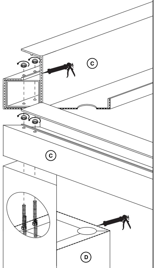
4. Vérifier si les diagonales sont identiques. Visser ensuite le renfort central (Vis C, Bouchon B, Perceuse et foret pour métal ø 4mm).
