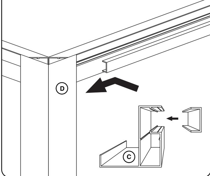
11. Visser les renforts (Vis C, Bouchon B, Perceuse et foret pour métal  $\varnothing 4\text{mm}$ ).
