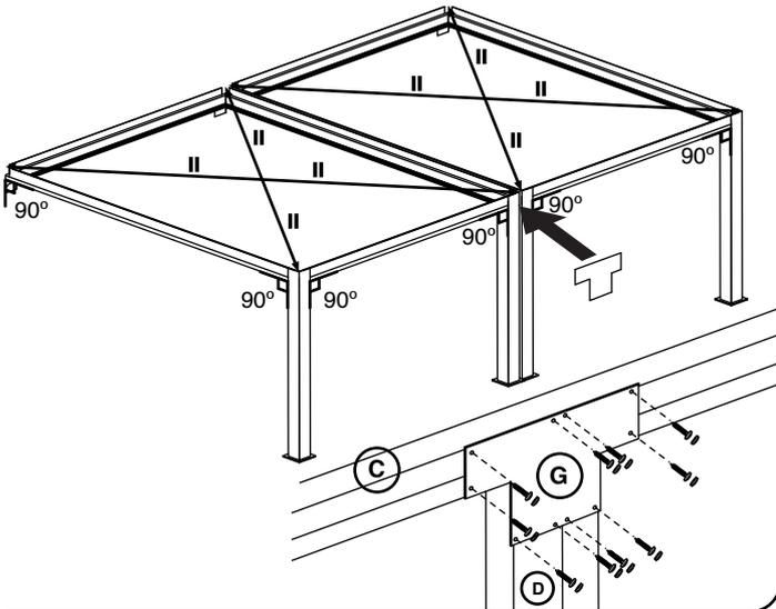
5. Fixer les montants au sol (Cheville, Rondelle Zinc, Vis A, Bouchon A). **ATTENTION:** Faire un trou dans les poteaux pour l'évacuation de l'eau (obligatoire), ø 30mm. Tous les pieds doivent être percés.
