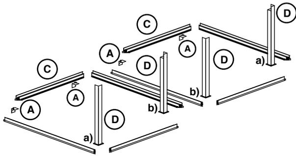
**ATTENTION** au sens des platines. Les deux platines du milieu sont posées côte à côte.
