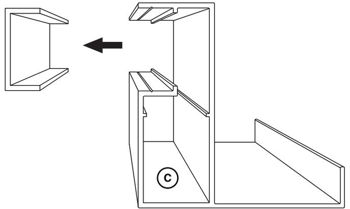
3. Fixer et silicuner les équerres au mur à la même hauteur que la partie supérieure du poteau (**Cheville, Rondelle Zinc, Vis A, Bouchon A**). Visser et silicuner les poutres gouttières aux piliers et aux équerres (**Écrou**). **ATTENTION:** Adapter vos fixations à votre support.
