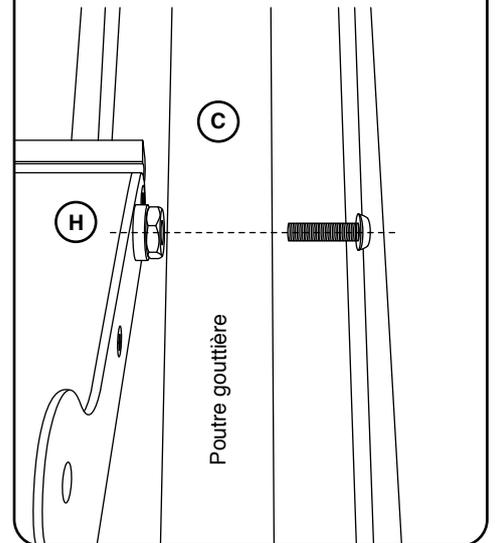
9. Placer la tringle sur les côtés (aux dessus des poutres gouttières) et visser sur l'oreillette percée de chaque lame (Vis Clamos + Rondelles Inox & Téflon).
