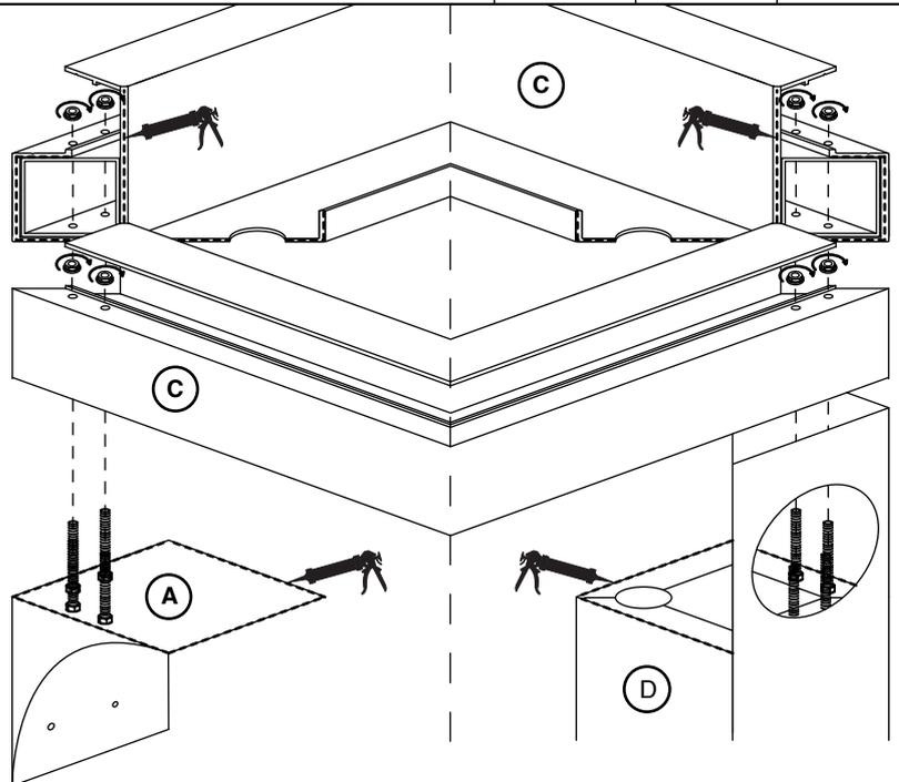
4. Vérifier si les diagonales sont identiques. Visser ensuite le renfort central (Vis C, Bouchon B, Perceuse et foret pour métal ø 4mm).
