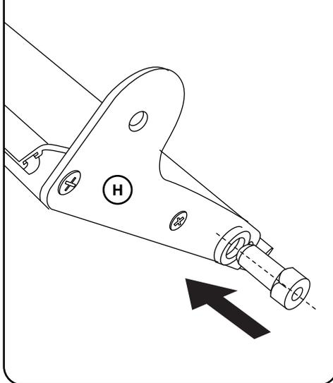
8. Positionner la lame et la deuxième partie de la vis afin de mettre définitivement en place la lame, puis serrer fort.
