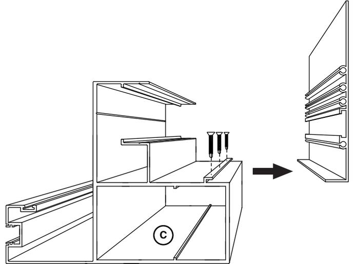
3. Fixer et silicuner les équerres au mur à la même hauteur que la partie supérieure du poteau (**Cheville, Rondelle, Vis A, Bouchon A**). Visser et silicuner les poutres gouttières aux piliers et aux équerres (**Écrou**). **ATTENTION** : Adapter vos fixations à votre support..
