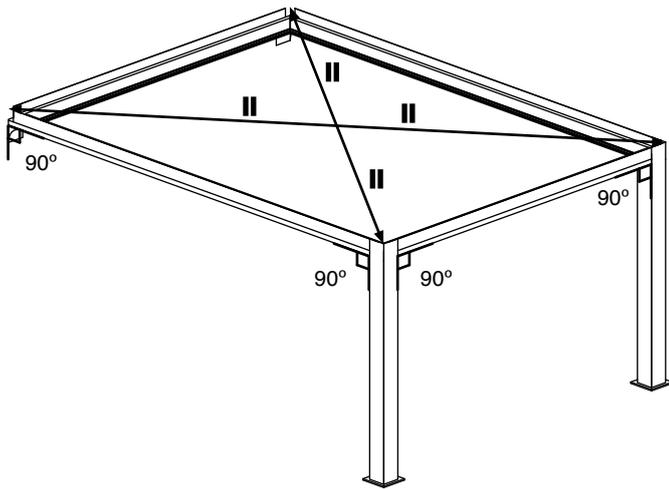
5. Fixer les montants au sol (**Cheville, Rondelle, Vis A, Bouchon A**).
