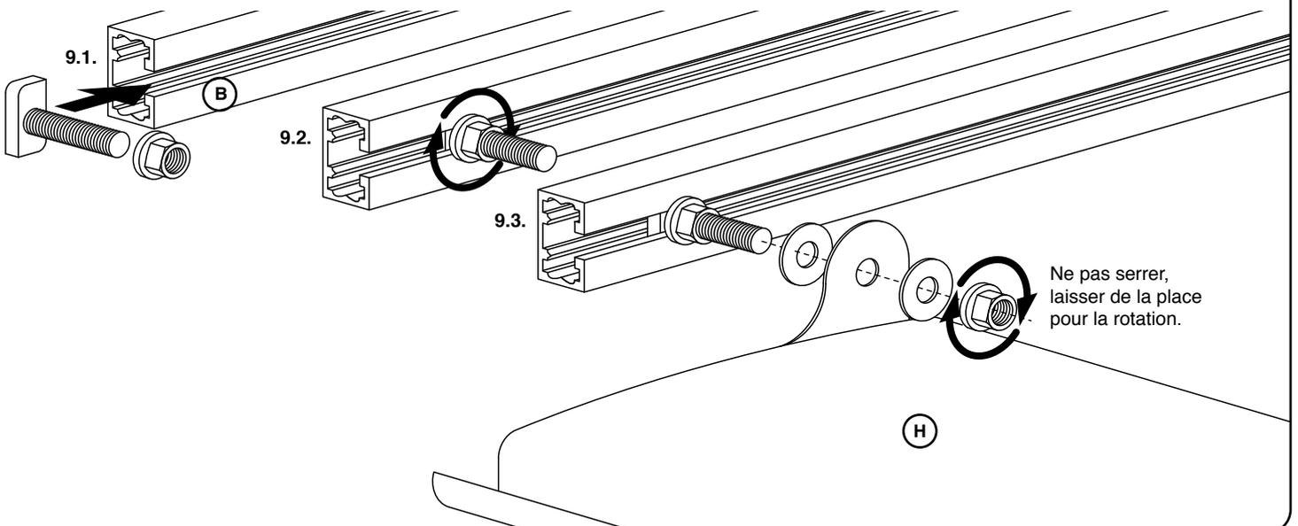
10. Fixation du moteur: Placer le support de fixation haut au centre de la tringle. Puis à l'aide d'un crayon, marquez pour percer les trous et visser la fixation (**foret 4mm pour percer et 8mm pour élargir, Vis Clamos, Vis M10**). Placer ensuite le support de fixation du bas, percez-la et vissez-la à son tour (**foret 4mm pour percer et 8mm pour élargir, Vis M10, Vis B, Bouchon B**).
