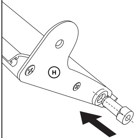
8. Positionner la lame et la deuxième partie de la vis afin de mettre définitivement en place la lame, puis serrer fort.
