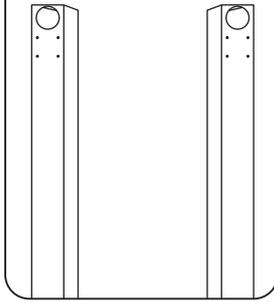
4. Dévisser puis revisser les poutres Ø100mm aux poteaux (2 vis dessus et 1 derrière) et silicuner le contour des poutres.
