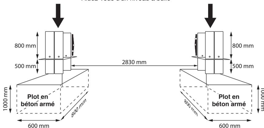
Faites réaliser les plots en béton armé par un professionnel selon la norme DTU 21
