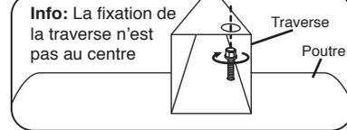
6. Percer les chevrons et mettre les panneaux de polycarbonate en butée. Fixer les chevrons à l'aide des vis et mettre les bouchons dans chaque trou avec du silicone. Assurez vous que l'eau ne pénètre pas dans le trou (Vis 5,5x32, Bouchon 2, Silicone).
