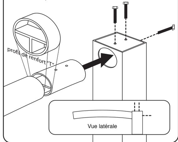
5. Placer les traverses et fixer les à l'aide des vis (Vis 5,5x32).
