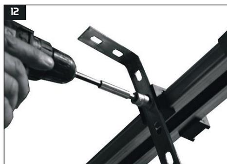
Insérez les pièces A dans le rail et fixez
