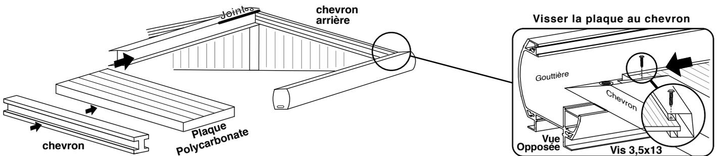
10. Après la 1<sup>o</sup> plaque, insérer le 1<sup>o</sup> petit chevron pour y emboîter la fenêtre. Une fois la fenêtre mise, insérer le 2<sup>o</sup> petit chevron et la petite plaque de polycarbonate pour compléter le tout.
