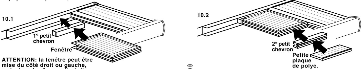
**ATTENTION:** la fenêtre peut être mise du côté droit ou gauche, mais dans les 2 cas, elle doit être au milieu du pan.
