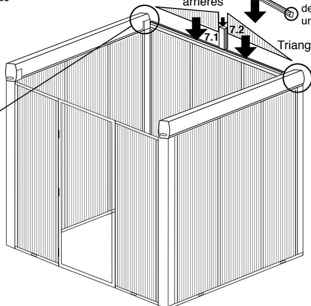
8. Emboîter puis visser maintenant la traverse centrale aux chevrons arrière. Commencer à insérer ensuite les joints sur la traverse centrale.
