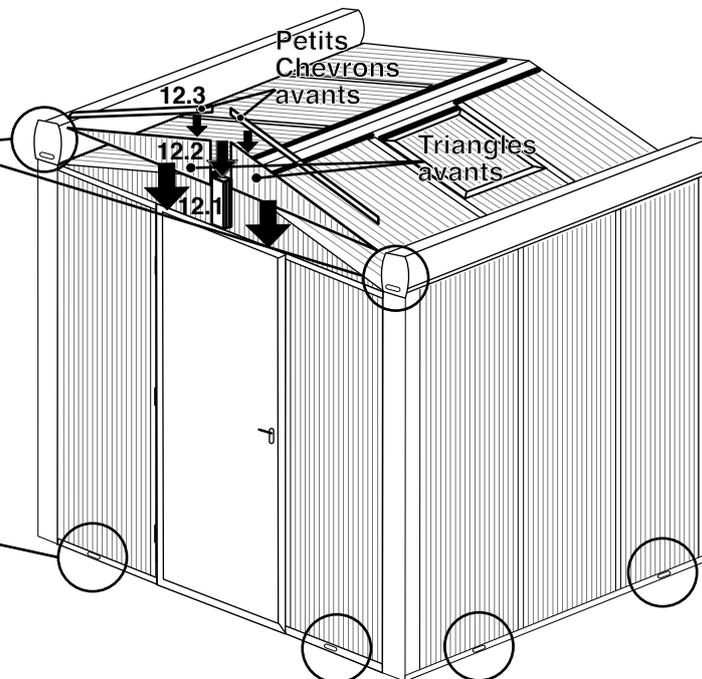
14. Visser les couvercles sur la partie haute des triangles. Siliconer ensuite chaque côté (et plaques) de la serre à l'extérieur et à l'intérieur comme indiqué sur le schéma ci-dessous:
