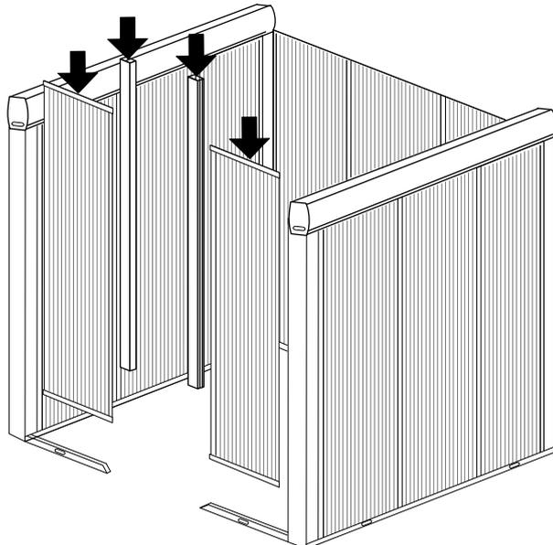
6. Placer le dormant de la porte entre les 2 plaques frontales. Sur la façade arrière, placer le grand chevron.
