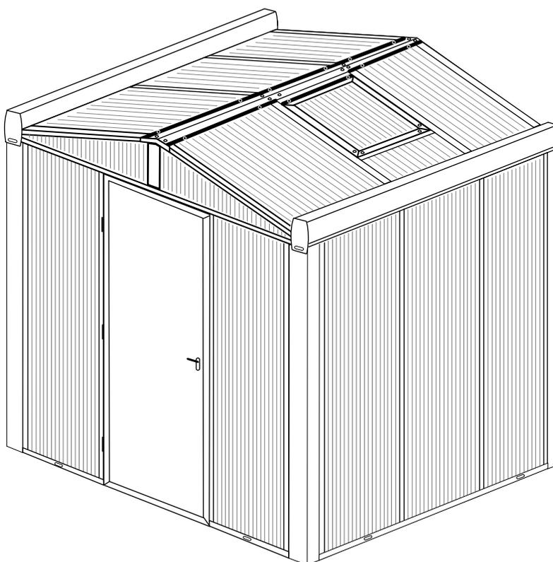
1. Assembler les piliers sur les 2 gouttières. Pour cela retirer les parecloses de celles-ci, puis y visser les piliers côté extérieur. Remettre ensuite les parecloses.
