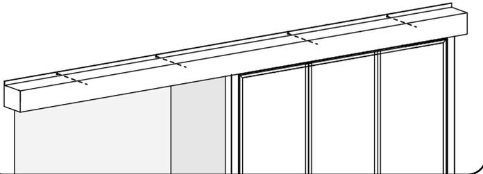
8. Remova o calço e ajuste os batentes e o trilho de guia (se necessário).
