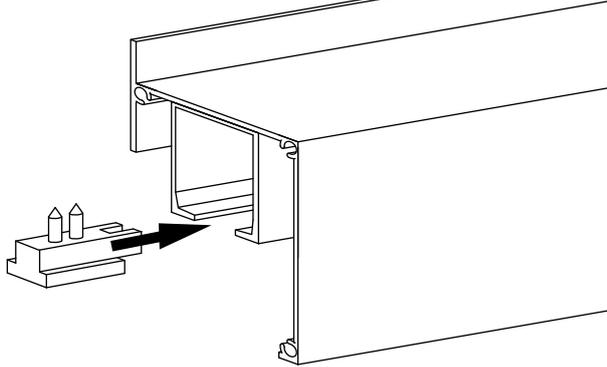
7. Fixe a outra tampa e faça deslizar o batente nivelado com a calha e aparafuse a tampa. (Parafuso 4,8x13).
