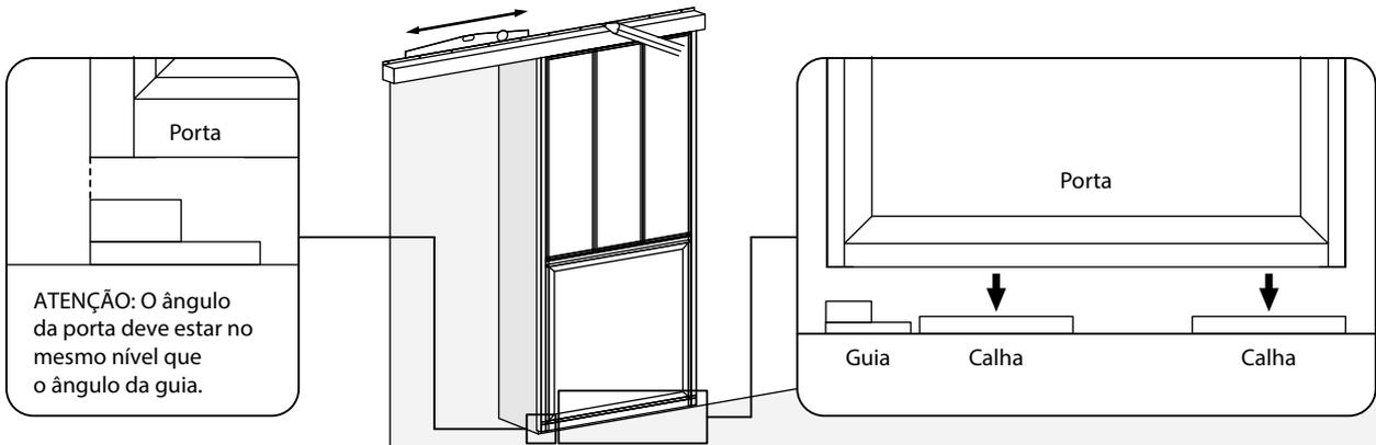
8. Perfurar e aparafusar o trilho à parede (Parafuso 4,8x60 + Bucha + Tampa) (8mm).
