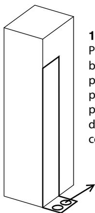
**1.1. Marcações das dobradiças do chão:** Posicionar o gabarito de furações contra a beira do pilar interior. Dobrar conforme o pontilhado, e o angulo assim obtido na parte inferior do pilar à altura do chão, permitir-lhe-á apontar os furos de fixação das dobradiças do chão que terá de colocar.
