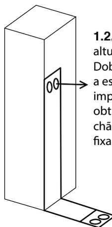
**1.2. Marcações das dobradiças:** Medir a altura do montante de seu portão. Dobrar o gabarito de furação exatamente a esta altura (consoante a graduação impressa no gabarito), o angulo assim obtido na parte inferior do pilar à altura do chão, permitir-lhe-á apontar os furos de fixação das dobradiças que terá de colocar.
