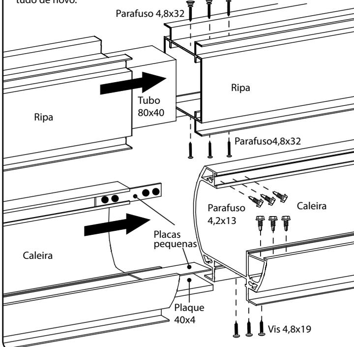
2. Colocar a Ripa de trás com uma inclinação mínima de 10% em relação á altura do pilar, verificar o nível e furar o muro com uma broca adapta (Ø 8mm) fixa-la ao muro.
