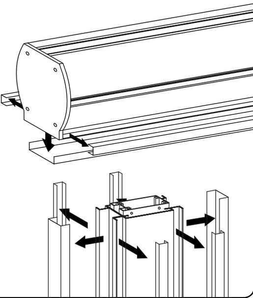
4. Aparafusar a caleira aos pilares e siliconar os parafusos e todo o seu redor.
