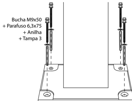
**ATENÇÃO:** Faça um furo nas colunas para drenagem de água (necessário), Ø 8mm. Todos os pés devem ser perfurados.
