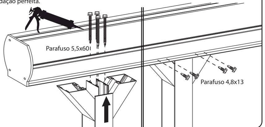
4. Coloque a placa de policarbonato da primeira viga. Prenda-o à ripa e à caleira (para esta última, aparafuse-o apertando as porcas do parafuso afinação).
