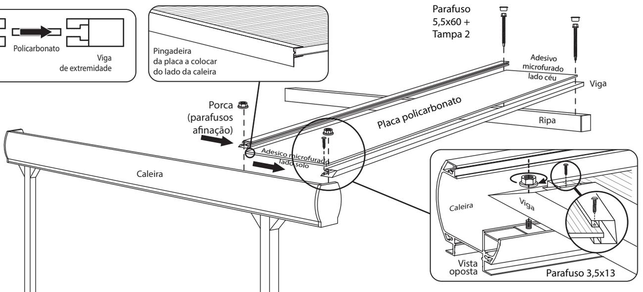
5. Coloque as placas de policarbonato em paragem até à última viga. Prenda-os à ripa e à caleira (para esta última, aparafuse-os apertando as porcas do parafuso Clamos).
