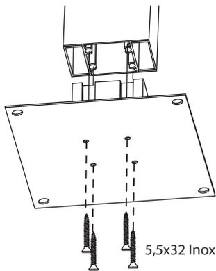
3. Aparafuse a caleira aos postes e siliconize as cabeças dos parafusos para garantir uma vedação perfeita.
