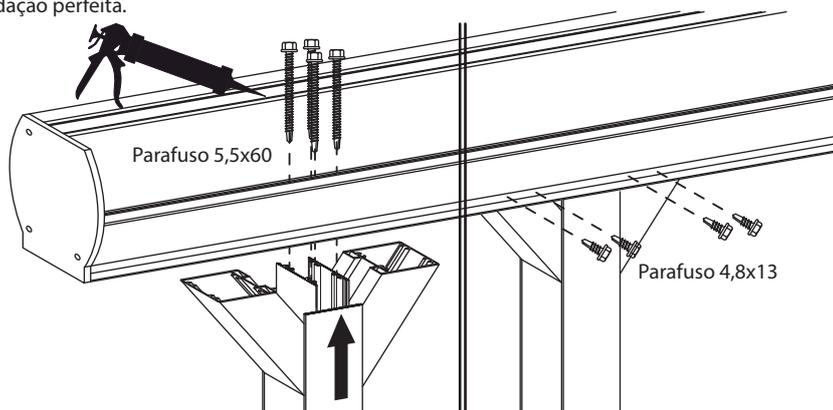
4. Coloque a placa de policarbonato da primeira viga. Prenda-o à ripa e à caleira (para esta última, aparafuse-o apertando as porcas do parafuso de afinação).
