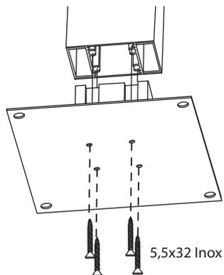
3. Aparafuse a caleira aos postes e siliconize as cabeças dos parafusos para garantir uma vedação perfeita.
