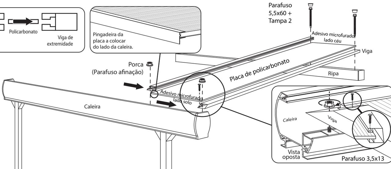
5. Coloque as placas de policarbonato em paragem até à última viga. Prenda-os à ripa e à caleira (para esta última, aparafuse-os apertando as porcas do parafuso afinação).
