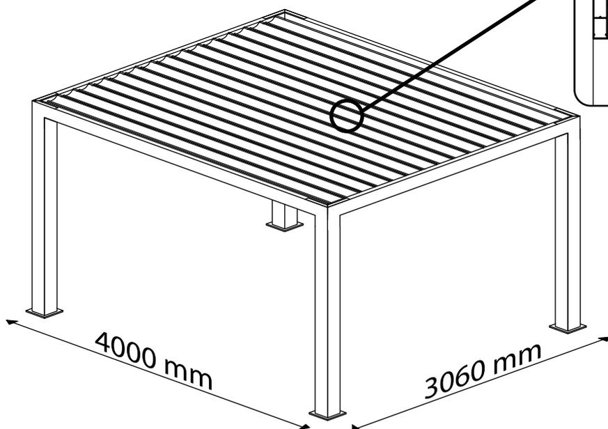
2. Colocar os pilares no local em função das cores dos suportes das vigas e das medidas da pergola, para colocar as caleiras.
