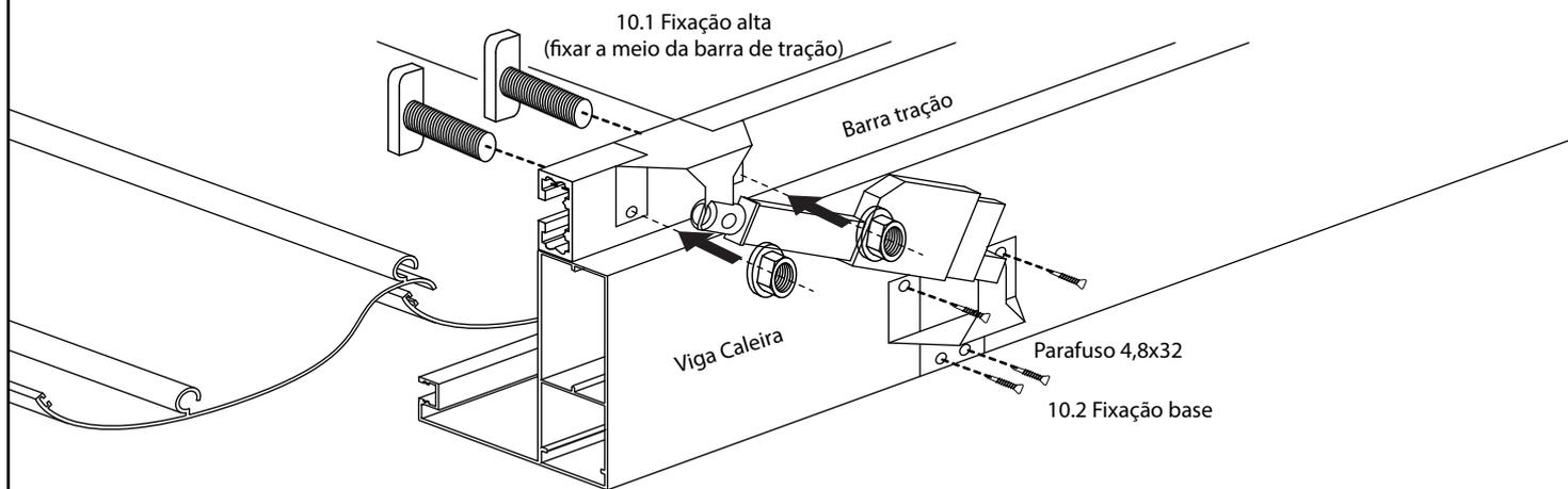
**ATENÇÃO:** Ao sentido das lâminas em relação ao motor e fixar o suporte motor superior ao meio da pergola.
