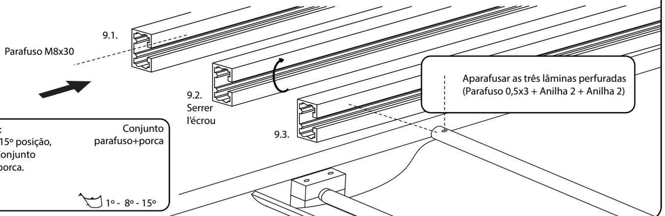
10. Fixação do motor: colocar o suporte de fixação superior a meio do triângulo e com a ajuda de um lápis, marcar e perfurar (9 mm) (conjunto parafuso pequeno + porca). Colocar de seguida o suporte de baixo e aparafusar.
