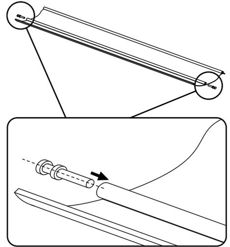
8. Posicionar os eixos dentro dos suportes. Ver o sentido das lâminas no esquema.
