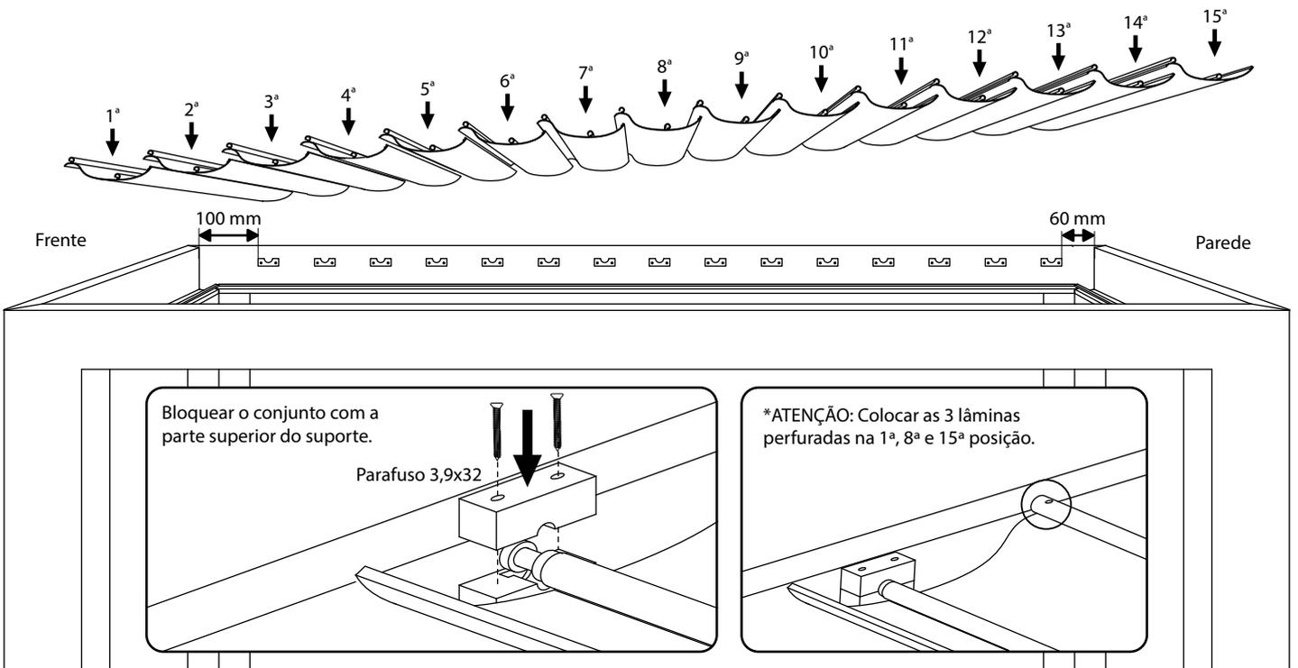
9. Colocar as barras de lado (por cima das vigas caleiras) e aparafusar no perfil.
