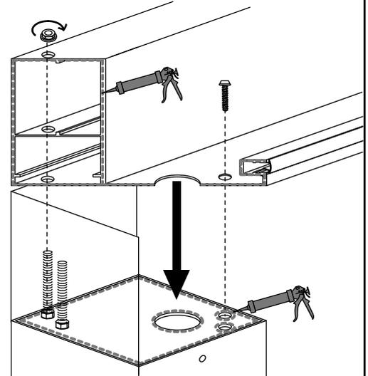
Retire o parafuso e a anilha para colocar a viga caleira no pilar. Uma vez colocado, fixe com o parafuso.
