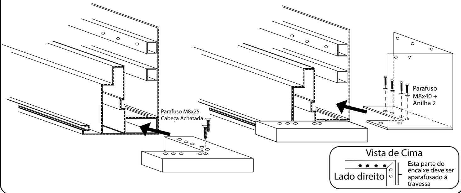
**2.** Aplicar silicone e aparafusar as caleiras aos pilares. Unir os pilares de acordo com as cores indicadas.
