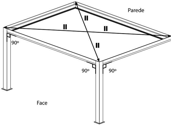
**4. Fixar os pilares ao chão aparafusando as sapatas.**
