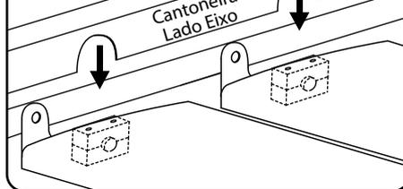
**6. Colocar as barras de lado (por cima das caleiras laterais) e aparafusar à aba furada de cada lâmina, como indicado abaixo.**
