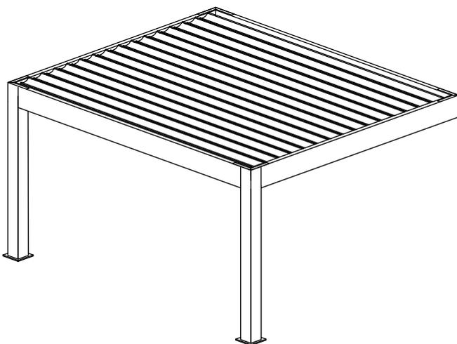
**1A.** Colocar os pilares no local em função das medidas da pérgola e colocar os perfis de caleiras de acordo com os conetores para ligação dos LEDs (seguir as cores).. **ATENÇÃO:** O quadro de comando já está fixado a uma das caleiras.
