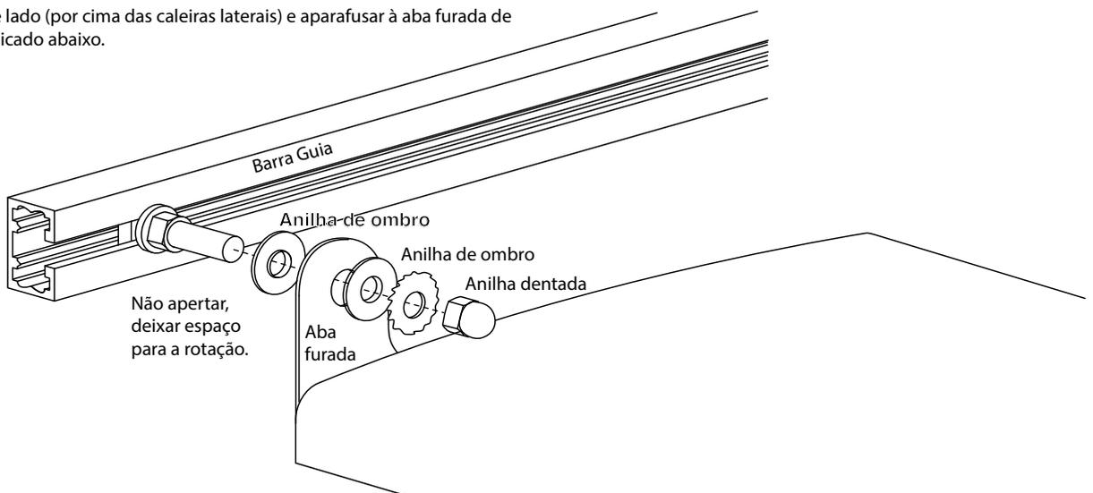
**7. Fixação do Motor:** Voltar a apertar o suporte de fixação inferior. Aparafusar de seguida o motor á barra e encaixar o parafuso.
