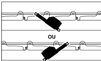
**ATENÇÃO:** Orientação das lâminas em relação ao motor. O suporte do motor está fixado no centro superior da barra guia. Se o motor não estiver na posição completamente fechada, corre o risco de danificar o material.
