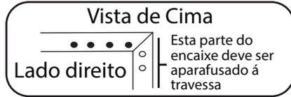
**2.** Fixar o reforço do lado esquerdo da travessa direita, afim de encaixar a segunda parte (esquerda) da travessa. De seguida aparafusar e colocar silicone nas caleiras e nos pilares. Unir os pilares seguindo as cores indicadas ao lado de cada uma.
