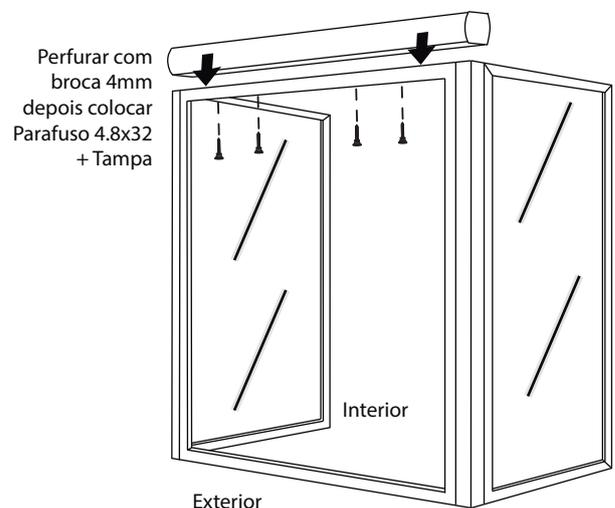
4. Quando a caleira estiver montada na marquise, perfure e fixe as travessas inferiores aos quadros fixos laterais.
