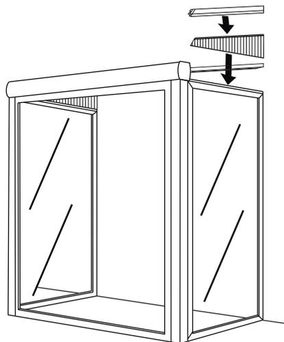
11. Siliconizar as partes unidas à parede. Insira a tampa lateral. Em seguida, coloque a folha esquerda primeiro na calha lá dentro.
