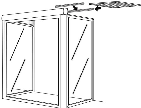
10. Colocar a placa trapézio do lado direito e sua viga superior.
