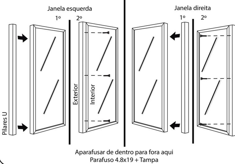
2B. Percer maintenant les fenêtres avec foret 3,5mm et le dormant avec foret 6mm afin de pouvoir les fixer les uns aux autres.
