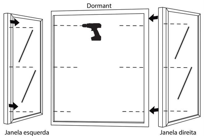
3. Aparafuse as janelas laterais fixas ao quadro fixo, tendo em conta as peças perfuradas anteriormente (ver 1.). Verifique o nível da Marquise.
