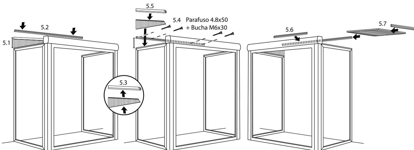
9. Agora coloque a tampa da extremidade direita na ripa para deslizar a 2ª placa de policarbonato da tampa.
