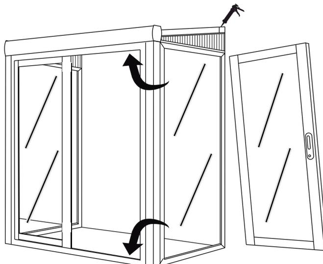
13. As 4 rodas situadas por baixo dos cursores (uma roda de cada lado dos controles deslizantes), são ajustáveis com uma chave Allen. Coloque a folha na posição fechada. Coloque a folha na posição fechada. Ajustar o parafuso da roda como mostrado abaixo até que a folha esteja paralela ao montante. Faça a mesma operação com as duas rodas de ambas as folhas. Para a fechadura, coloque o atacante com a chave Allen na posição dependendo da posição da fechadura.
