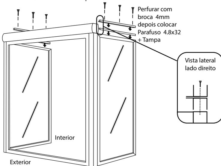
5. Meça a largura da sua marquise e coloque os bites na parede de acordo com esta medição. Tenha o cuidado de ter em conta ao colocar os bites para deixar uma margem de 0,5 cm de cada lado, a fim de encaixar correctamente a marquise. Depois, aparafuse-os à parede e coloque a marquise neles. Em seguida, siliconize as partes fixas à parede e ao chão.
