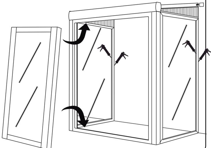
12. Silicone na tampa lateral. Em seguida, insira a folha direita na calha exterior.
