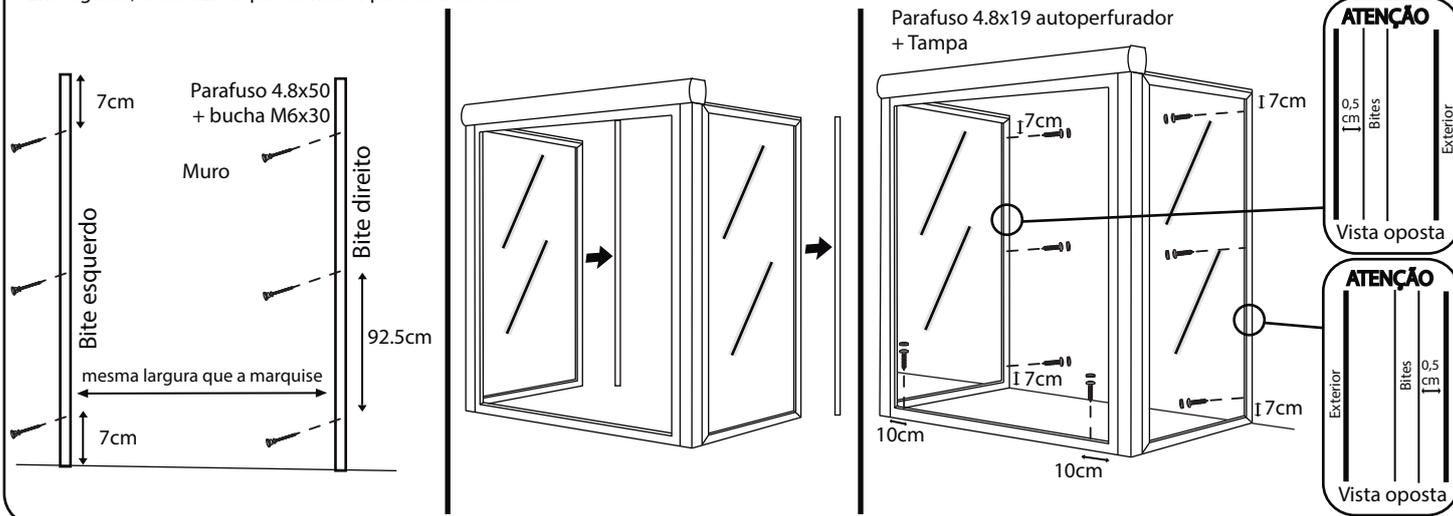
5. Coloque a placa de policarbonato trapézio sem prendê-la para descobrir onde colocar a ripa, em seguida, retire a viga superior da placa para ser capaz de fixar a ripa à parede. Uma vez fixada a ripa, colocar primeiro a placa trapézio do lado esquerdo e a sua viga superior. Em seguida, coloque na ripa, a sua tampa da extremidade esquerda para deslizar a 1ª placa de policarbonato da tampa e a viga central.
