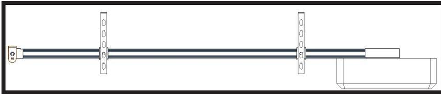
6- Aparafuse a fixação do braço do motor na porta seccionada com os parafusos apropriados;
