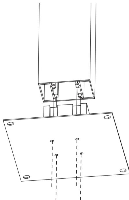
3. Aparafuse a caleira aos pilares e siliconize os parafusos e seu torno.
