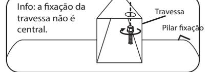
6. Furar as travessas de fixação e encaixar os painéis de policarbonato. Aparafusar as travessas de fixação com a ajuda dos parafusos e colocar as tampas com silicone em cada buraco, assegure-se que não entre água nos buracos (parafuso5, tampa2 e silicone)
