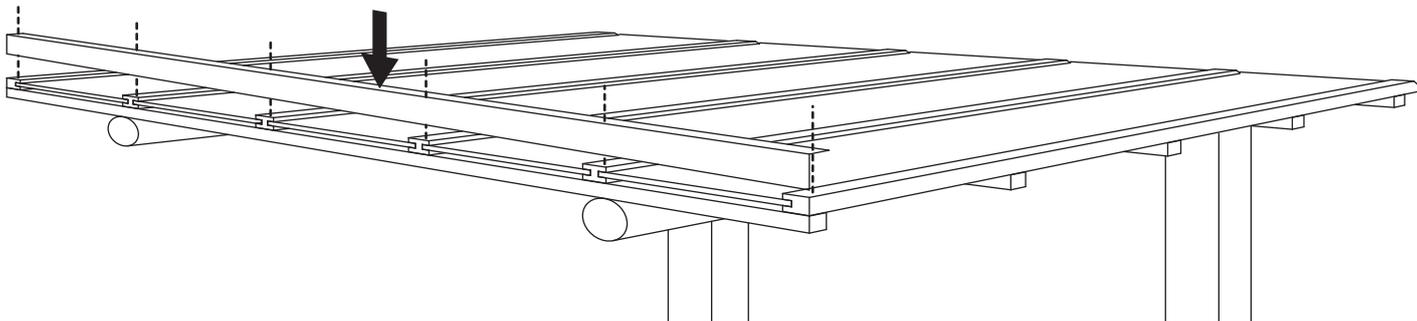
8. Fixar a caleira (porca, parafusos clamos). Caleira e travessa de fixação
