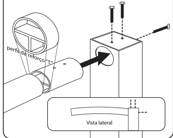
5. Colocar as travessas e fixar com a ajuda dos parafusos (Parafuso 5,5x32).
