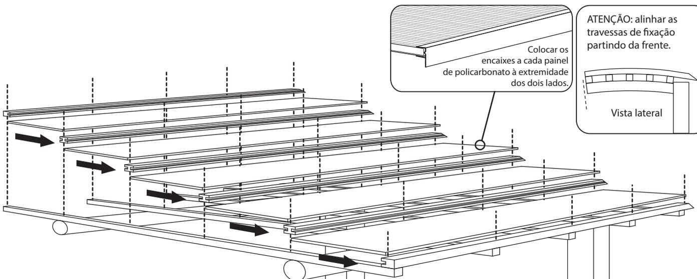
Colocar os encaixes a cada painel de policarbonato à extremidade dos dois lados.
