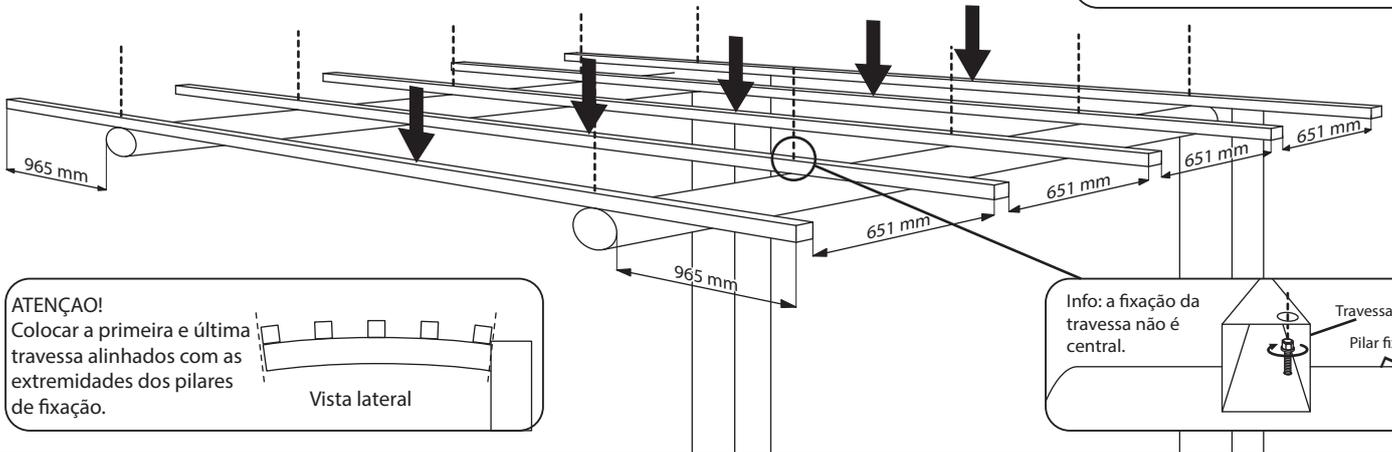
ATENÇÃO! Colocar a primeira e última travessa alinhados com as extremidades dos pilares de fixação.
