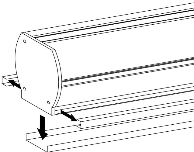
2. Encaixar as caleiras com a placa 40x4 (parafuso 4,8x32) e as pequenas placas (parafuso 4,2x13)
