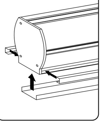
5. Aparafusar as duas primeiras travessas de fixação e colocar uma placa de policarbonato entre elas (porca)
