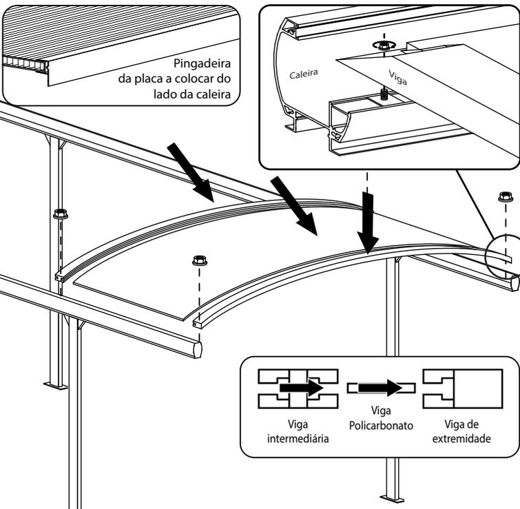
6. Aparafusar o perfil plano nas travessas de fixação afim de garantir o espaçamento entre as travessas curvadas (parafuso 4,8x32, tampa 1)
