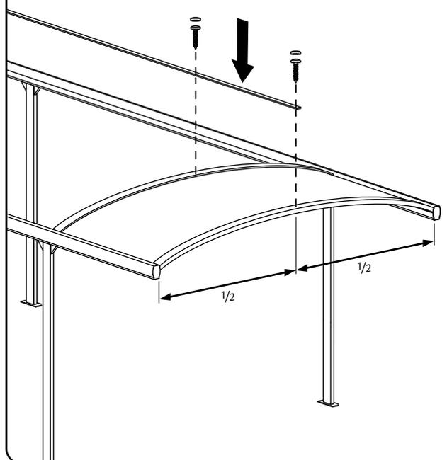
7. Repetir os pontos 5. e 6., até à última travessa de fixação (porca, parafuso 4,8x32, tampa 1)
