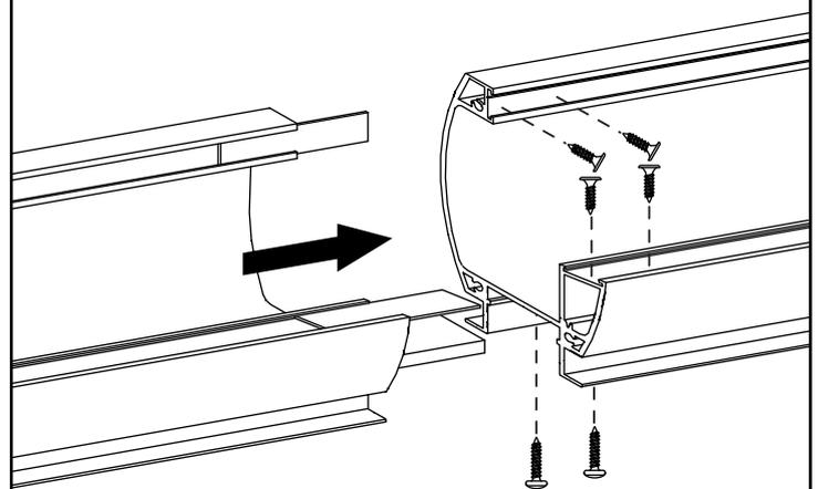
3. Aparafusar a caleira aos pilares e vedar com silicone os parafusos (parafuso 4,8x13)
