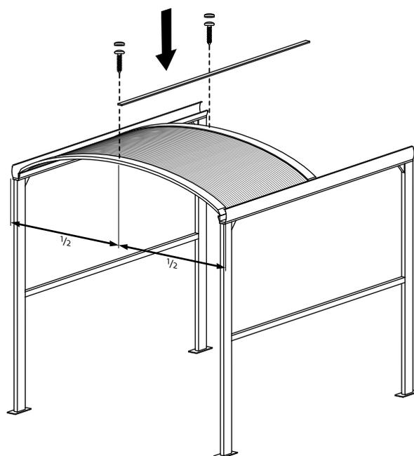
7. Repetir os pontos 5 e 6 para a última viga (porca, parafuso 4,8x19, tampo 1)
