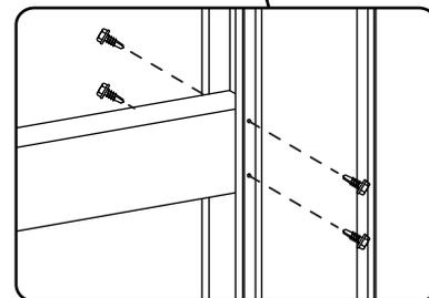
3. Aparafusar os caleiros aos pilares e colocar silicone para vedar (parafuso 4,8x13)
