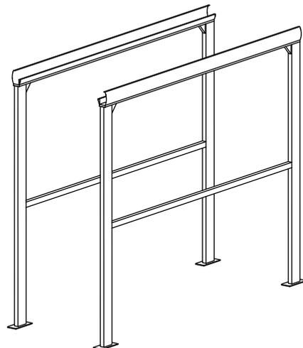
5. Aparafusar as duas primeiras travessas e colocar uma placa de policarbonato entre elas (porca)
