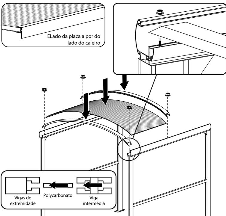
6. Aparafusar o perfil achatado sobre a travessa para garantir a abertura entre as travessas curvas
