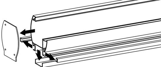
2. Colocar a travessa reforçada entre os dois pilares e aparafusar lateralmente. (parafuso 4,8x13)
