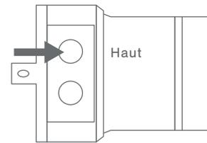
1. Tournez la vis "haut" pour régler la position de la limite d'ouverture.
