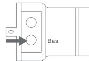
2. Tournez la vis "bas" pour régler la position de la limite de fermeture.
