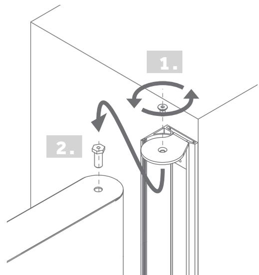
**5.** Installer le bas du vantail en introduisant l'axe du bas et par pivotement, positionner le haut du portail sous le gond du haut.
