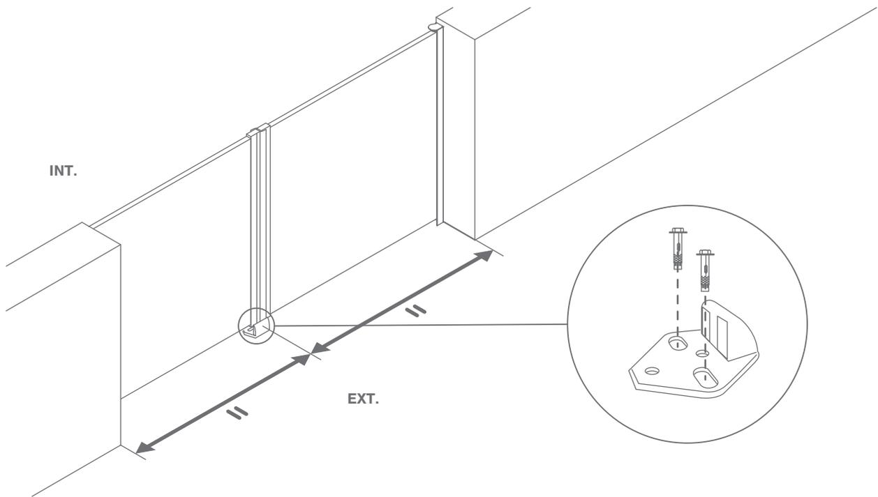
**ENTRETIEN DU PORTAIL:** Penser à lubrifier les gonds et crapaudines 2 fois par an avec un aérosol en téflon type WD40. Le nettoyage du portail peut être fait à l'eau savonneuse tiède.
