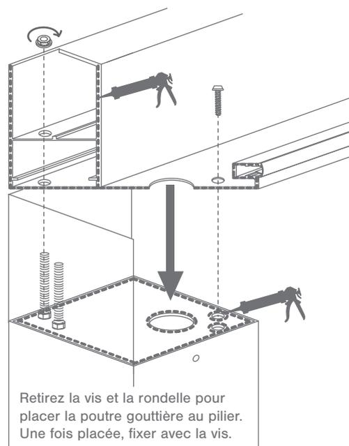
Retirez la vis et la rondelle pour placer la poutre gouttière au pilier. Une fois placée, fixer avec la vis.
