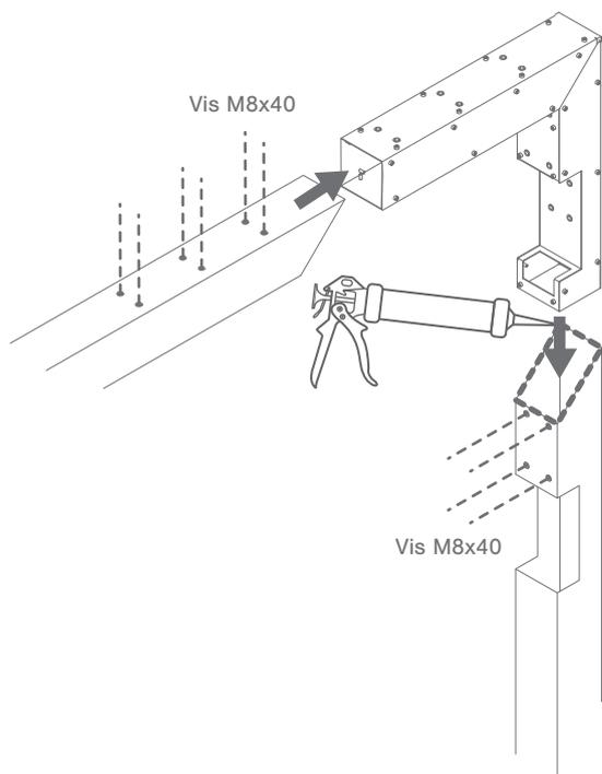
**2.** Mettez du silicone sur la platine et à l'intérieur du pilier. Insérez ensuite la platine sur le pilier, en veillant à ce que le drainage de l'eau soit dirigé. Vissez la platine au pilier avec des vis 5,5x32.
