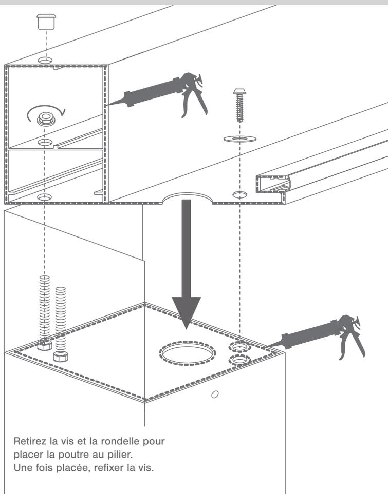
Retirez la vis et la rondelle pour placer la poutre au pilier. Une fois placée, refixer la vis.
