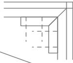
**2** Placez les plaques en aluminium (en forme de V) entre la plaque de fixation et les arêtes formées par triangles de polycarbonate; Cela ira permettre de fixer les triangles de polycarbonate aux arêtes principales de façon empêcher l'eau de couler à l'intérieure de la Pergola.
