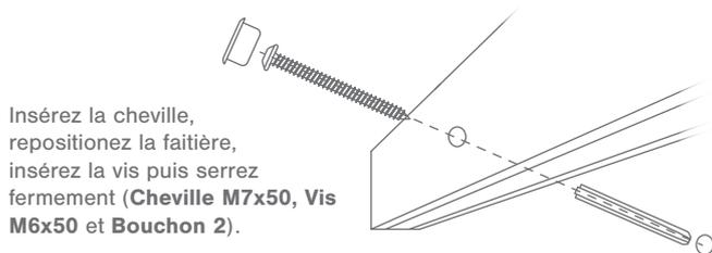
Insérez la cheville, repositionnez la faitière, insérez la vis puis serrez fermement (Cheville M7x50, Vis M6x50 et Bouchon 2).
