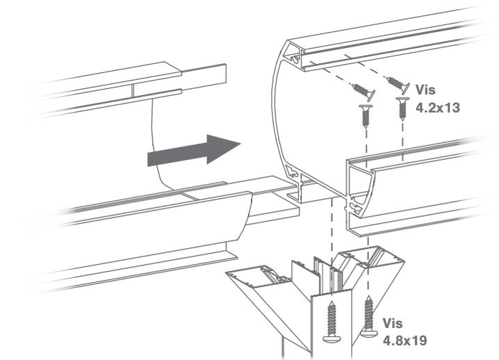
**3.** Placer la faitière avec une pente minimale de 10% par rapport à la hauteur du poteau, vérifier le niveau et fixez-la au mur.
