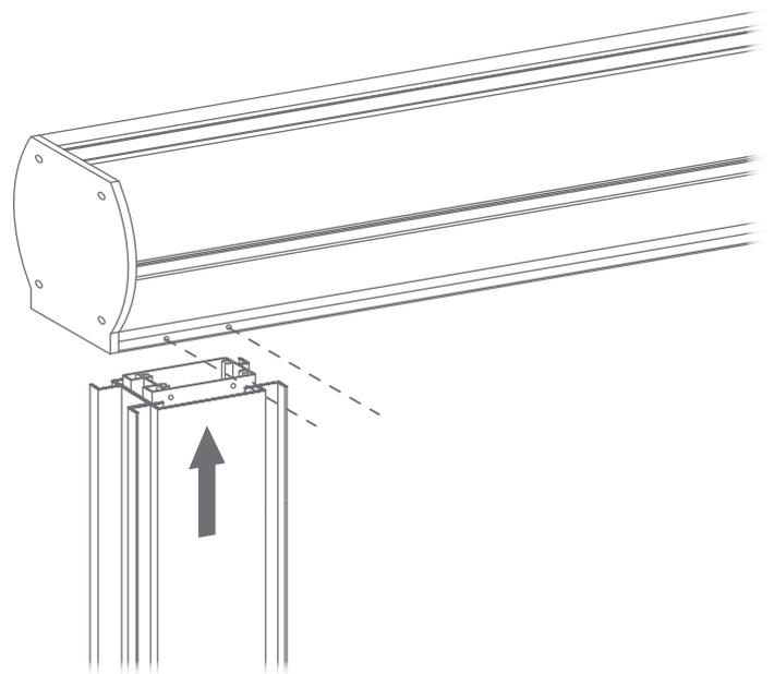
**OPTION:** Fixer les renforts si nécessaire (Vis 4,8x13).
