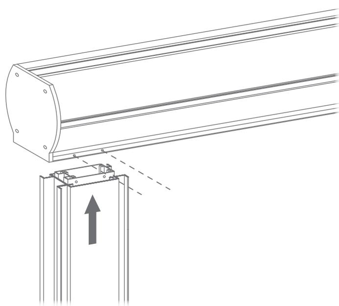
**OPTION:** Fixer les renforts si nécessaire (Vis4,8x13).
