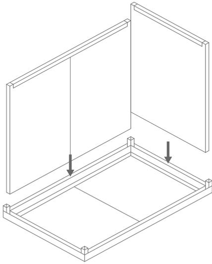
**2.** Insérez les profils de support dans les angles.
