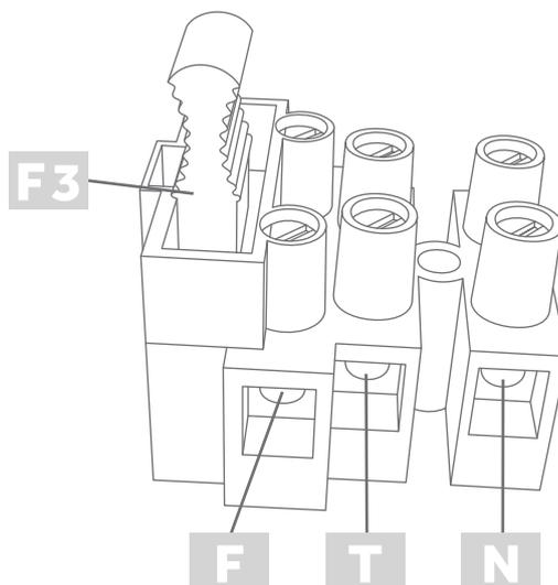
Connecter la phase, pour la protection de l'entrée 230VAC (3.15A)
