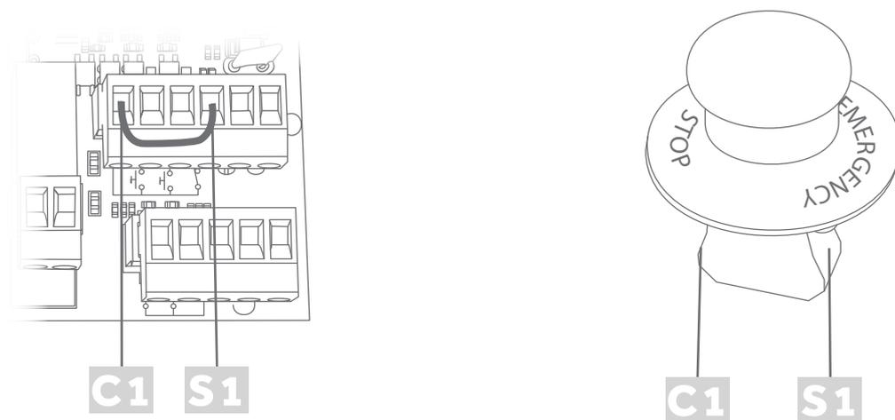
Ce contact, doit être obligatoirement fermer (NC) pour que la carte électronique SWG24 puisse fonctionner, si ce contacte est ouvert le moteur s'arrête et ne bouge plus jusqu'a ce que le contact soit fermer. Il doit être connecter comme ceci:
