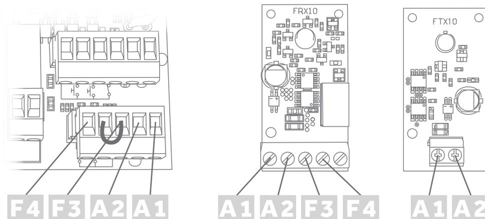
La carte électronique SWG24 électronique doit être connecté au contact normalement fermé (NC) photocellule
