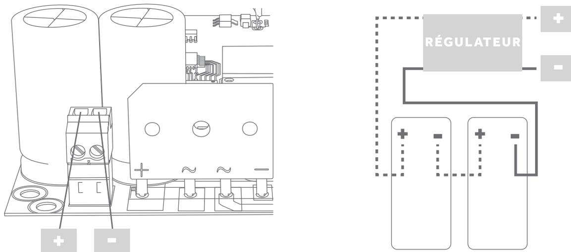
Cette sortie est prête à recevoir 2 batteries 12V-1.3AH(min) a plomb, connectés en série avec le régulateur respectif.
