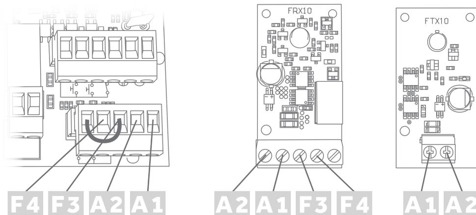
La carte électronique SWG24 doit être connecté au contact normalement fermé (NC) photocellule et retirer le shunt.
