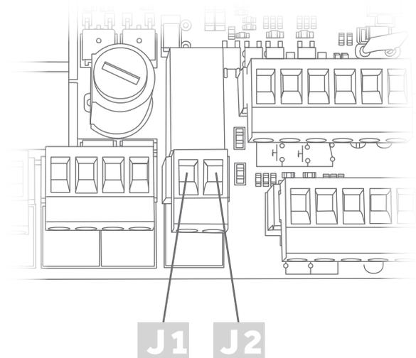
Contact normalement ouvert (NO) sans tension. Après l'arrêt du moteur cette sortie est active pendant 120 secondes.
