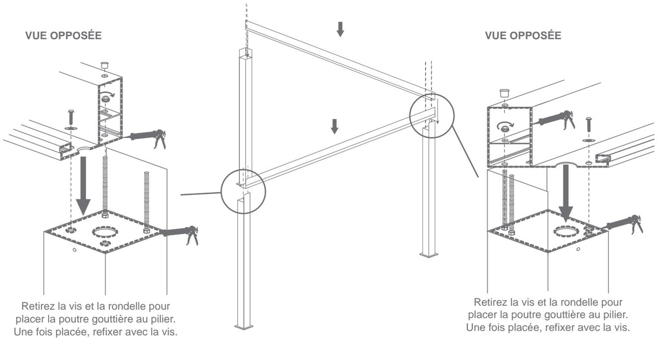
Retirez la vis et la rondelle pour placer la poutre gouttière au pilier. Une fois placée, refixer avec la vis.
