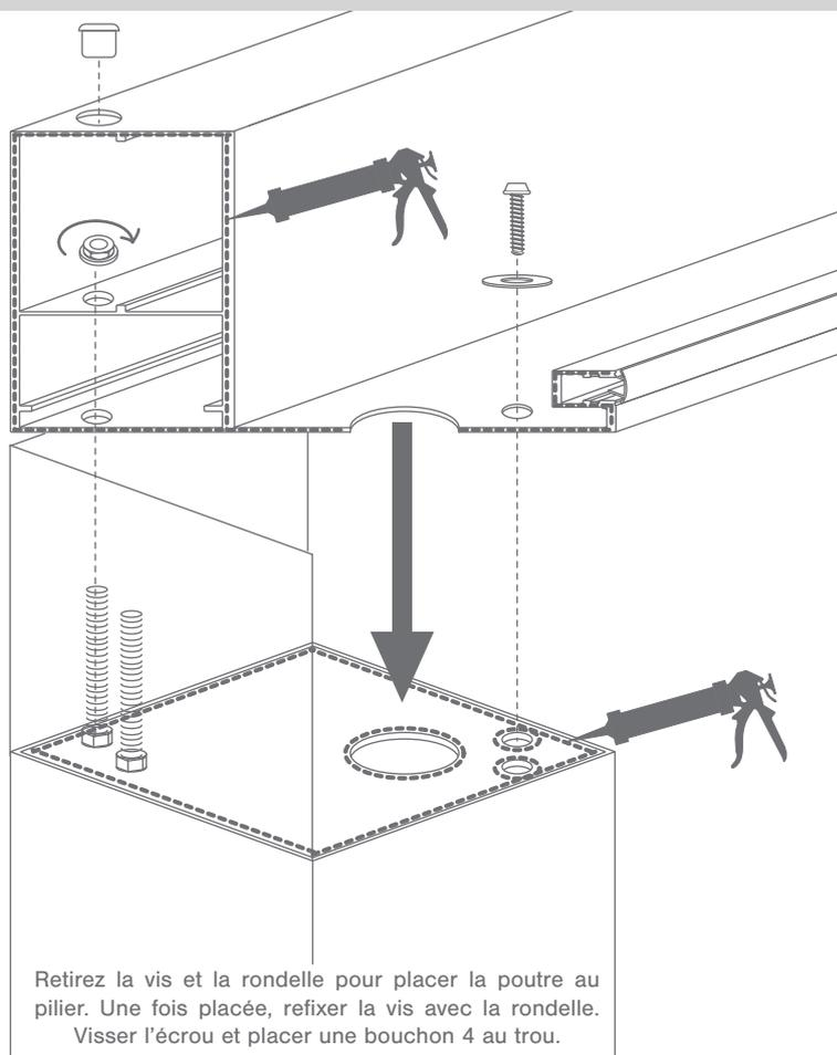
Retirez la vis et la rondelle pour placer la poutre au piliers. Une fois placée, refixer la vis avec la rondelle. Visser l'écrou et placer une bouchon 4 au trou.
