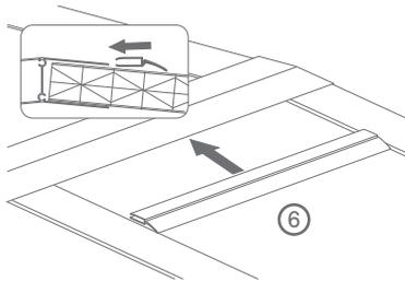
6. Assemblez le joint entre la traverse centrale et les plaques de polycarbonate.
