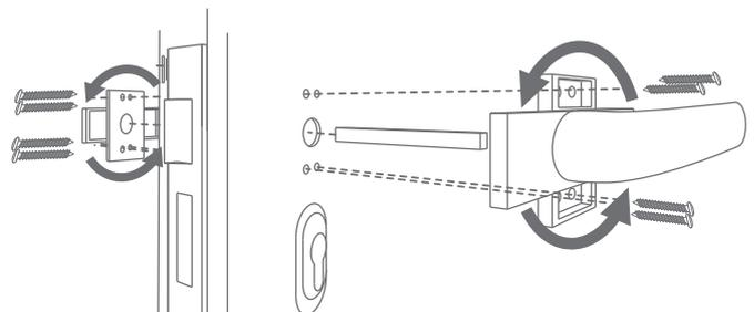
Pour installer la poignée, retirez d'abord les vis de la porte. Prenez la poignée puis tournez le haut pour déverrouiller les ouvertures de fixation. Vissez ensuite la poignée sur le battant de porte.
