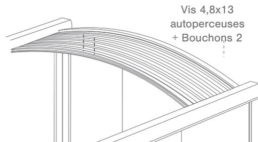
5. Fixez le dernier profil à la plaque avec des vis auto-perceuses 4,8x13 et des bouchons 2.
