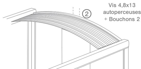
2. Fixez la plaque au centre du profil en U avec des vis auto-perceuses 4,8x13 et des bouchons 2.
