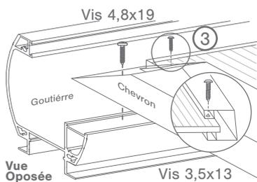
3. Fixez la plaque aux extrémités du profil en U avec des vis 3,5x13
