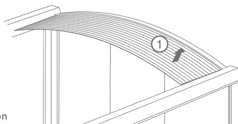
1. Insérez la plaque de polycarbonate dans la rainure du profil en U.
