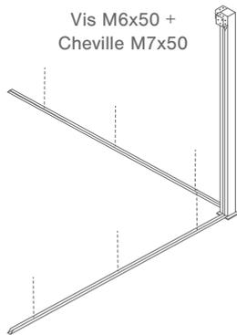
**7.** Prenez les mesures du panneau de façade et placez des cales dans les extrémités afin que le panneau ne soit pas en contact avec le sol. (Faites-le sur tous les panneaux)
