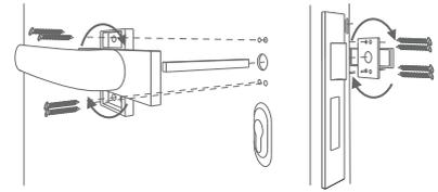
Pour placer la poignée, retirer d'abord les vis de la porte. Prenez votre poignée puis faite tourner la partie supérieure pour débloquer les ouvertures de fixations. Revisser ensuite la poignée au vantail.
